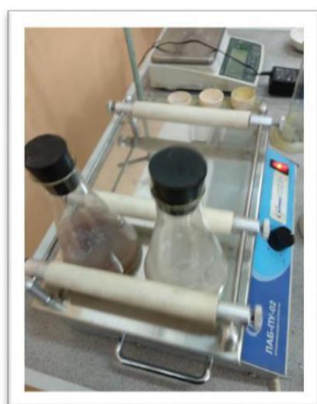
Рисунок 5. Ротационный аппарат для встряхивания.
