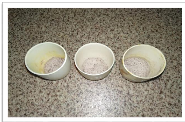
Рисунок 4 - Продукты термообработки смесей фосфорной кислоты с отходами обогащения марганцевой руды м.Жайрем
